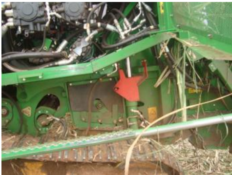
Figura 02 – Exemplo de travas de cilindros hidráulicos.
