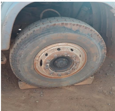
Figura 03 – Exemplo de aplicação dos calços em rodas.
