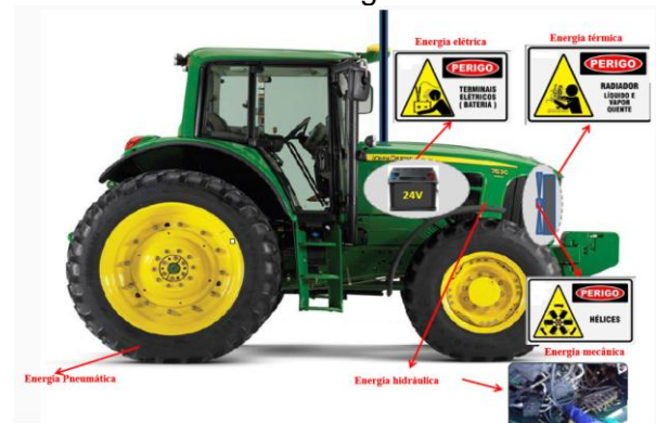
Figura 1 – Exemplo de Energias Perigosas em um Trator Agrícola.
