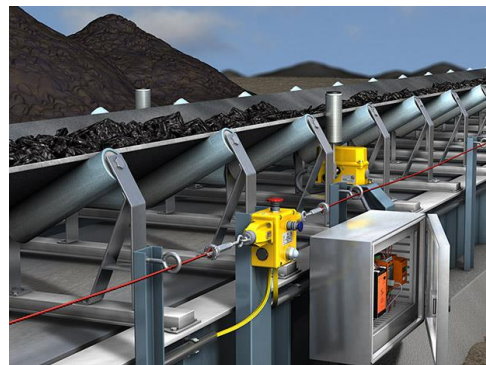
Figura 5 – Cabo de segurança instalado em esteira transportadora.
