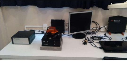
Figura 1: Equipamento AFM utilizado para avaliar a frequência de ressonância.
