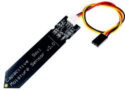
Figura 1: Sensor capacitivo de baixo custo utilizado no experimento.
