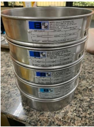
Figura 8 – Série Peneiras Tyler 05, 08, 09, 14 Mesh mais o prato coletor.
