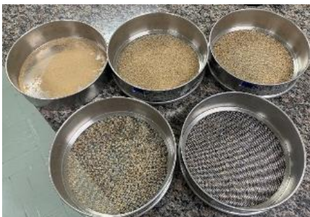
Figura 9 – Série Peneiras Tyler 14, 24, 35, 60 com amostras de pó de malte retidas (MSM) vistas por cima.
