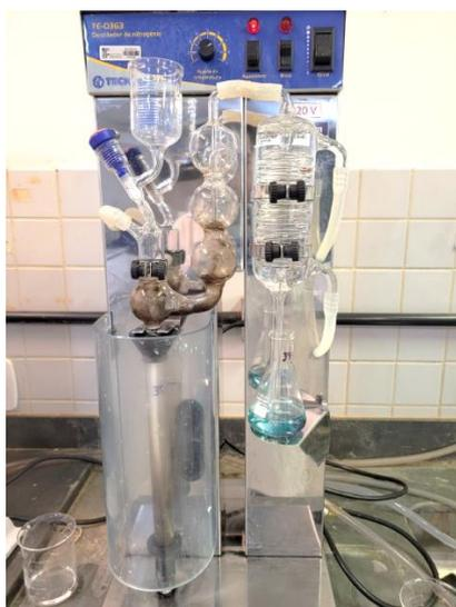
Figura 1: Destilador de nitrogênio Tecnal TE-0363<sup>®</sup>
