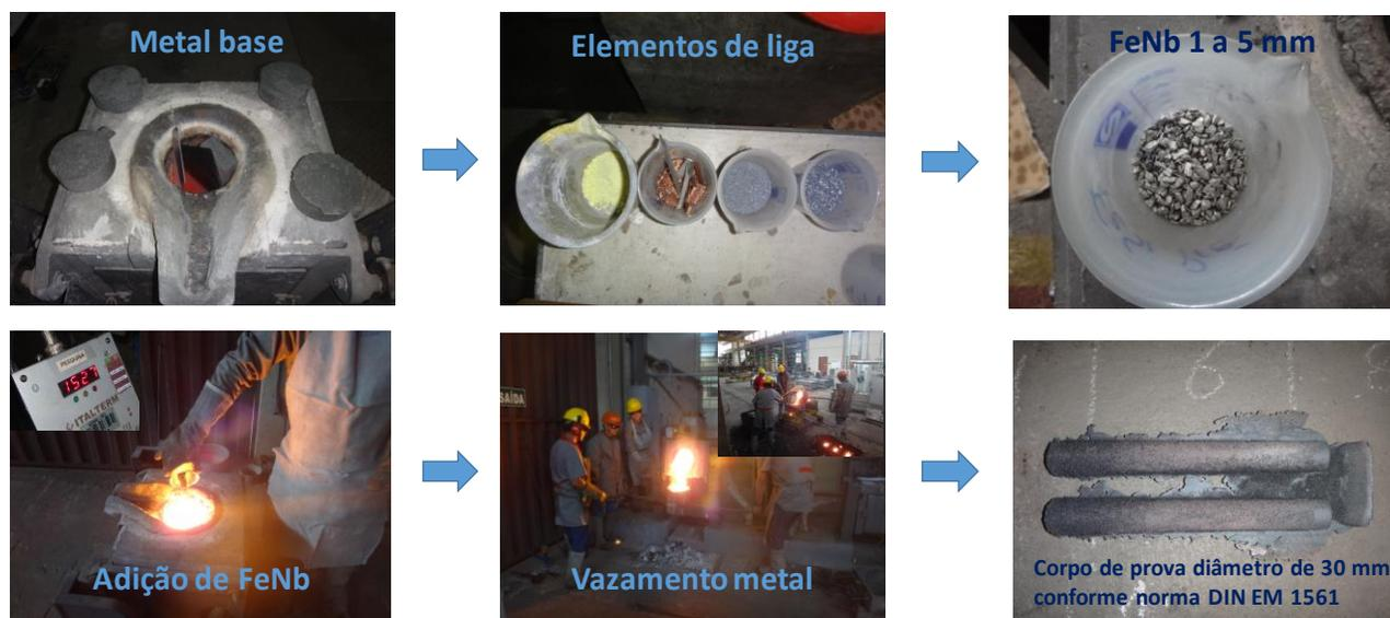
**Figura 2** - Fundição de corpos de prova de ferro fundido cinzento conforme procedimento pré-estabelecido pelos autores para fabricação de corpos de prova
