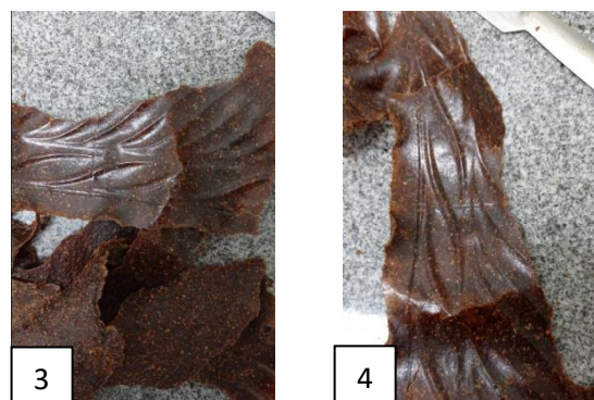
Figura 3 e 4: Experimento 2 – 8% de glicerol e 2,50% de gelatina – Fig (3 e 4), molde na garrafa PET.
