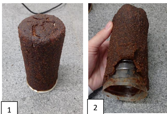
Figura 1 e 2: Experimento 1 – 8% de glicerol e 2,50% de gelatina – Fig (1), molde de alumínio e Fig (2), molde na garrafa PET.
