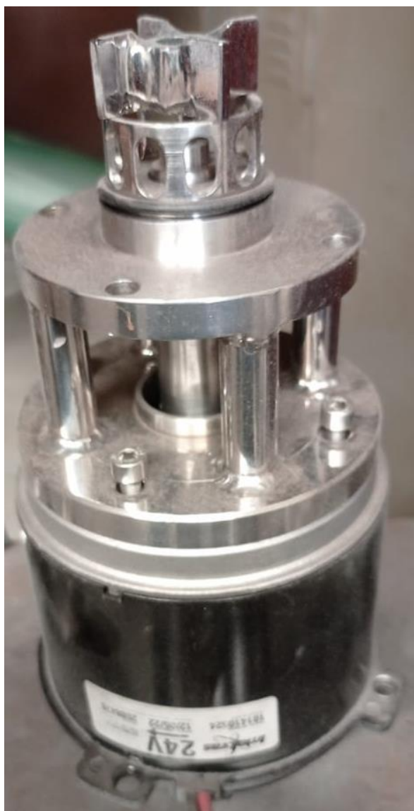
Figura 6: Agitador central com motor elétrico Fonte: Acervo dos autores
