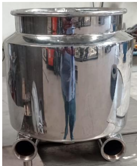
Figura 4: Reator com entradas finalizadas Fonte: Acervo dos autores
