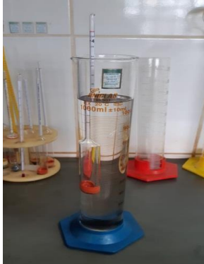
Figura 1: Determinação da Densidade do Etanol Hidratado Combustível.
