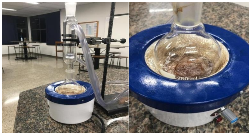
Figura 1 - Experimento 1 - Refluxo com álcool isoamílico, ácido acético e ácido sulfúrico P.A.
