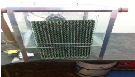
Figura 8: Instalação da colméia de celulose
