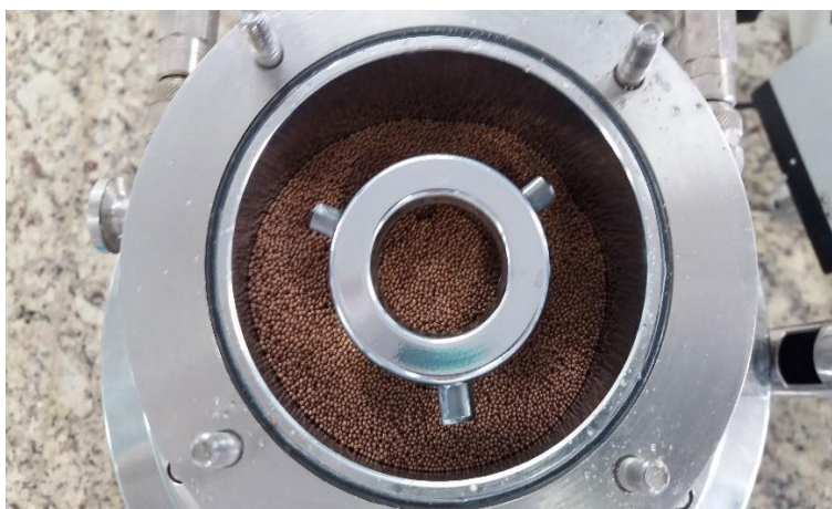
Figura 4: Moinho sendo preenchido com 80% de Esferas de Zircônio. Fonte: Acervo do Autor.
