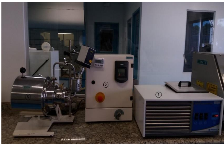
Figura 7: Identificações do Moinho MiniZeta II E (1 – Banho Termostatizado; 2 – Painel de Controle; 3 – Recipiente Coletor; 4 –Câmara de Moenda; 5 –Motor).
