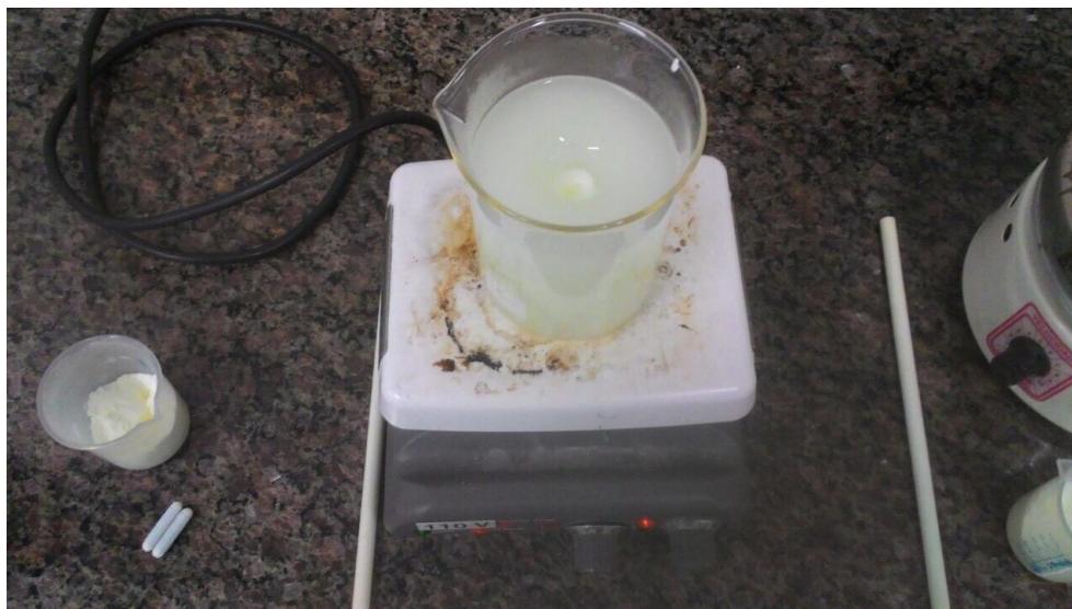
Figura 1: Gelatinização do amido de milho. Fonte: Autora 2017.
