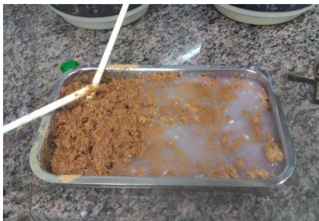
Figura 2: Mistura de fibra resina de adesão. Fonte: Autora 2017.
